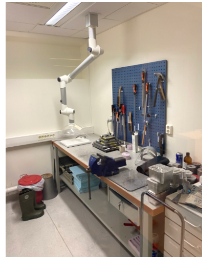
Figur 34: Lite verksted med puktavsug og stråleovn, St. Olavs Hospital, Trondheim. Foto: Sykehusbygg HF
