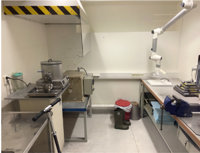
Figur 34: Lite verksted med puktavsug og stråleovn, St. Olavs Hospital, Trondheim. Foto: Sykehusbygg HF
