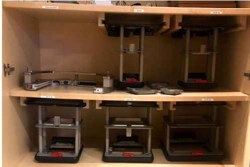
Figur 47: Elektrontubuser – tilleggsutstyr til linak. Foto: Sykehusbygg HF.
