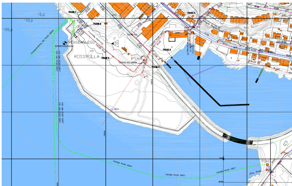
Figur 7-32: Hammerfest har nylig bygd nytt renseanlegg for spillvann fra hele byen nord på Rossmolla. Det er to pumpeledninger i sjø og en over land hit som kan bli berørt av en sykehusutbygging
