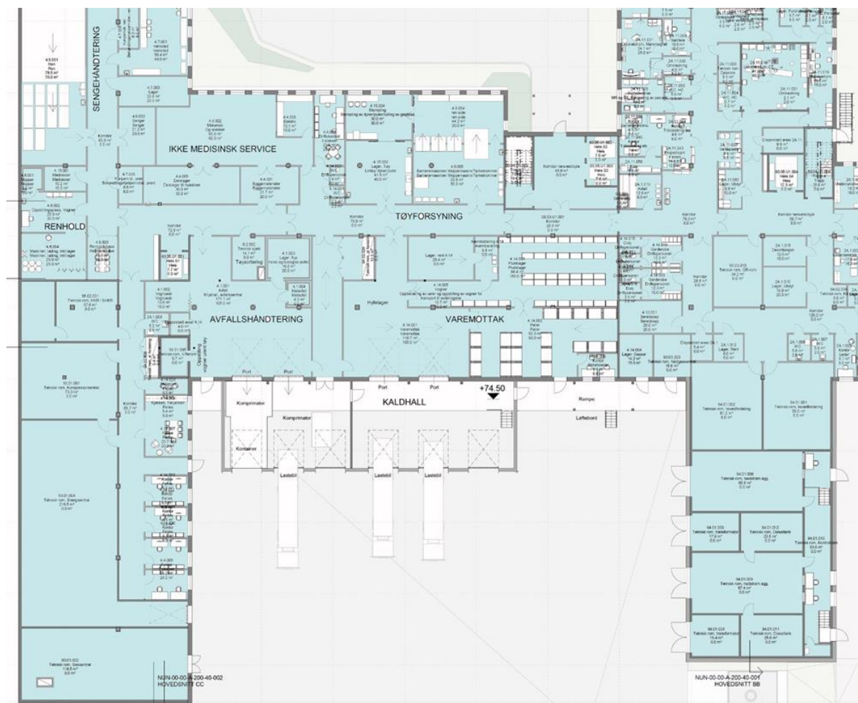
Figur 26 Varemottak med kaldhall og sidefløy med nødstrømsaggregater og hovedtavler
