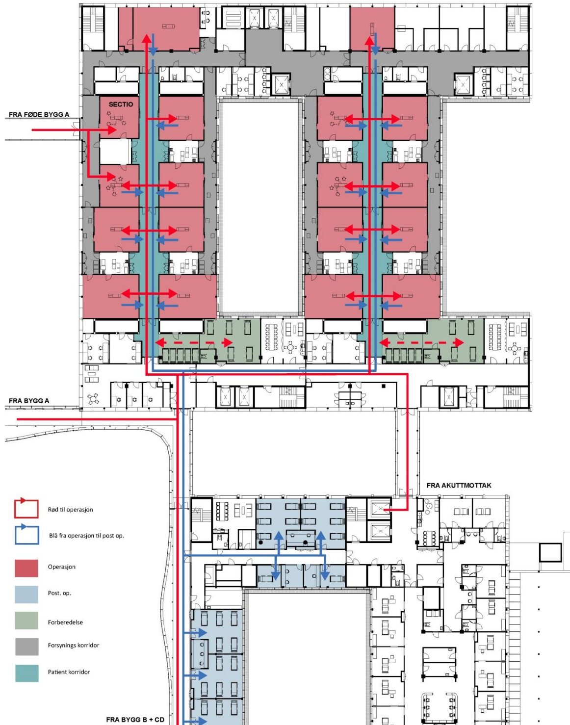
Figur 30 Behandlingsbygget, 3 etg. flow for operasjon og postop
