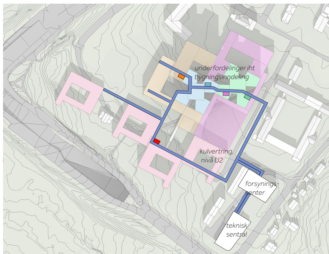
Prinsipp teknisk forsyning
