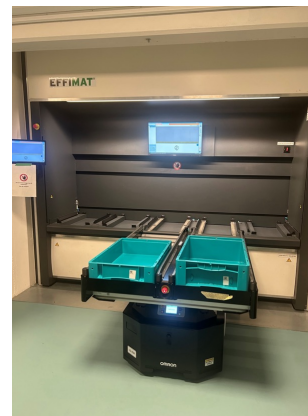
AMR transport og innlagring i varelagerautomat, Stavanger universitetssjukehus Foto: Sykehusbygg
