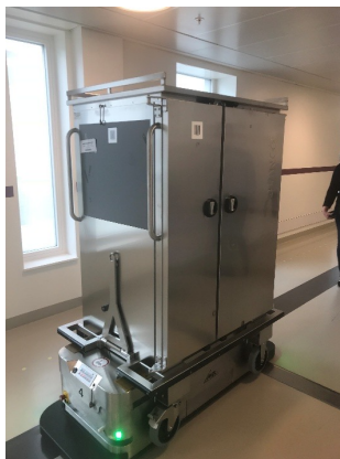
AGV transportvogn for mat, Østfoldsykehuset Foto: Sykehusbygg
