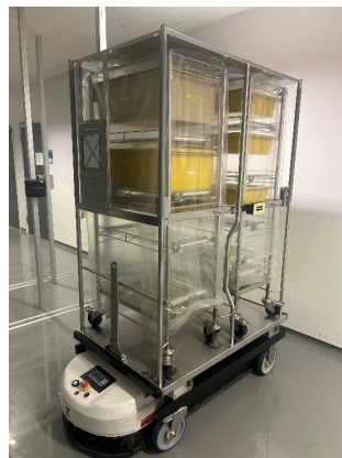
AGV transportvogn for sterilt utstyr, St. Olavs hospital Foto: Sykehusbygg
