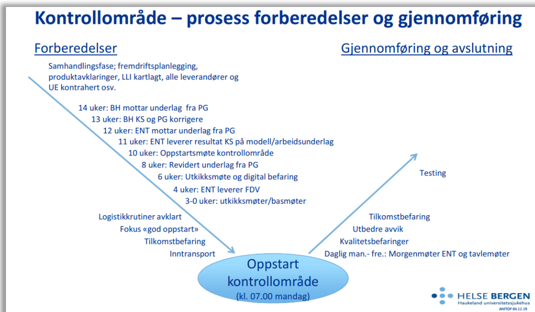
Figur 36: Eksempel på at dokumentasjon er en del av Lean Construction prosesser for å ferdigstille arbeidsunderlag. Både modell og FDV-dokumentasjon er en del av planlagt leveranse før oppstart.
