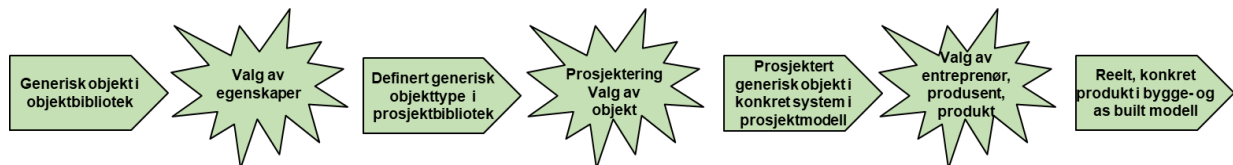
Figur 19. Modellen bygges opp fra generiske objekter som berikes / utvikles til produktspesifikke
