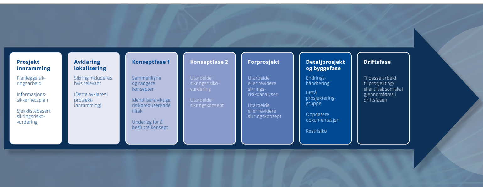
Figur 4. Prosjektsteg og arbeid med sikring.
